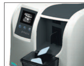
Płytki obrazowe są wyrzucane automatycznie.
