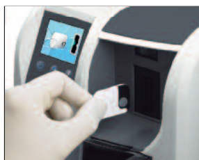
Automatyczne otwieranie drzwiczek skanera
