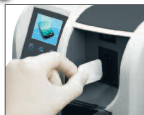
Automatyczne rozpoznawanie rozmiaru włożonej płytki
